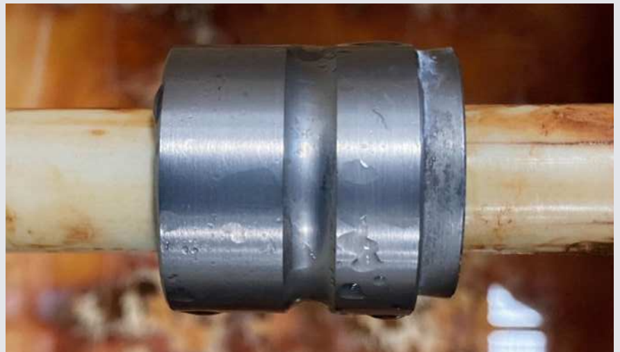
Aro interior de SKF después de 160 horas de niebla salina con una oxidación roja mínima
